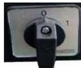
1. Accendere il Rotary Switch (interruttore ON/OFF sul pannello di controllo) -> vedere sezione 5.
